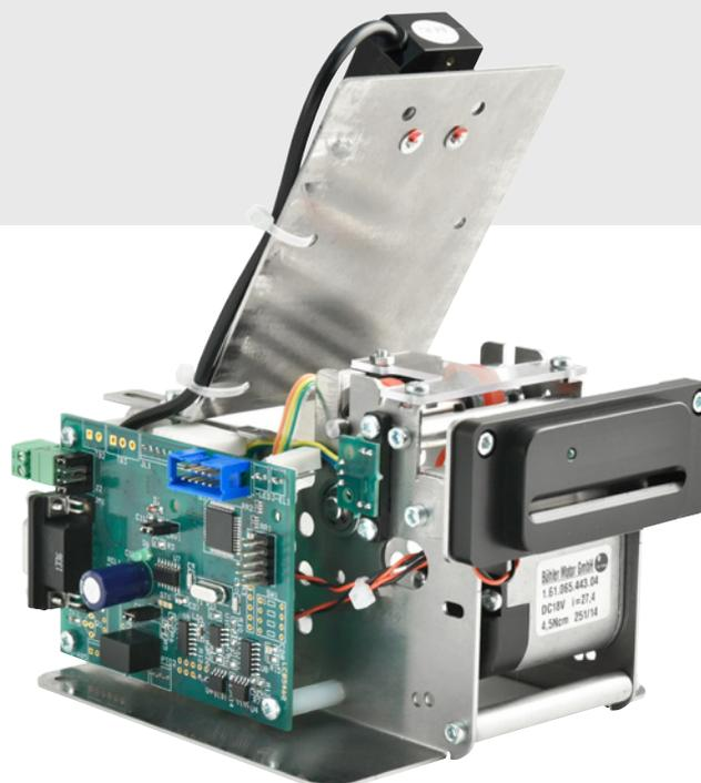
Ce lecteur motorisé de badges sans contact a été conçu pour les applications de contrôle d'accès nécessitant une fonction avalement des cartes. La lecture est possible uniquement lorsque la carte est insérée.
