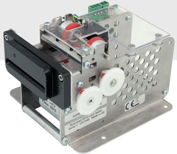
Ce lecteur motorisé de badges sans contact a été conçu pour les applications de contrôle d'accès nécessitant une fonction avalement des cartes.
